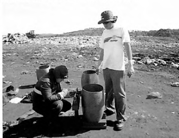
Figura 17 – Etapas de um dos quarteamentos realizados no aterro de Apucarana.
